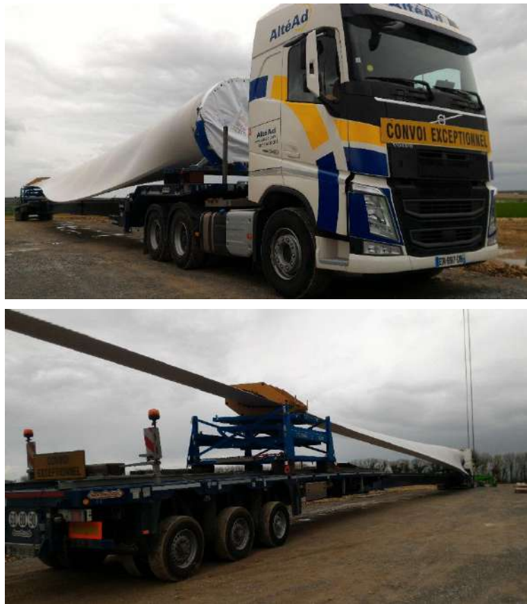
Figure 63 : Transport des pales (Source : VOLKSWIND)
