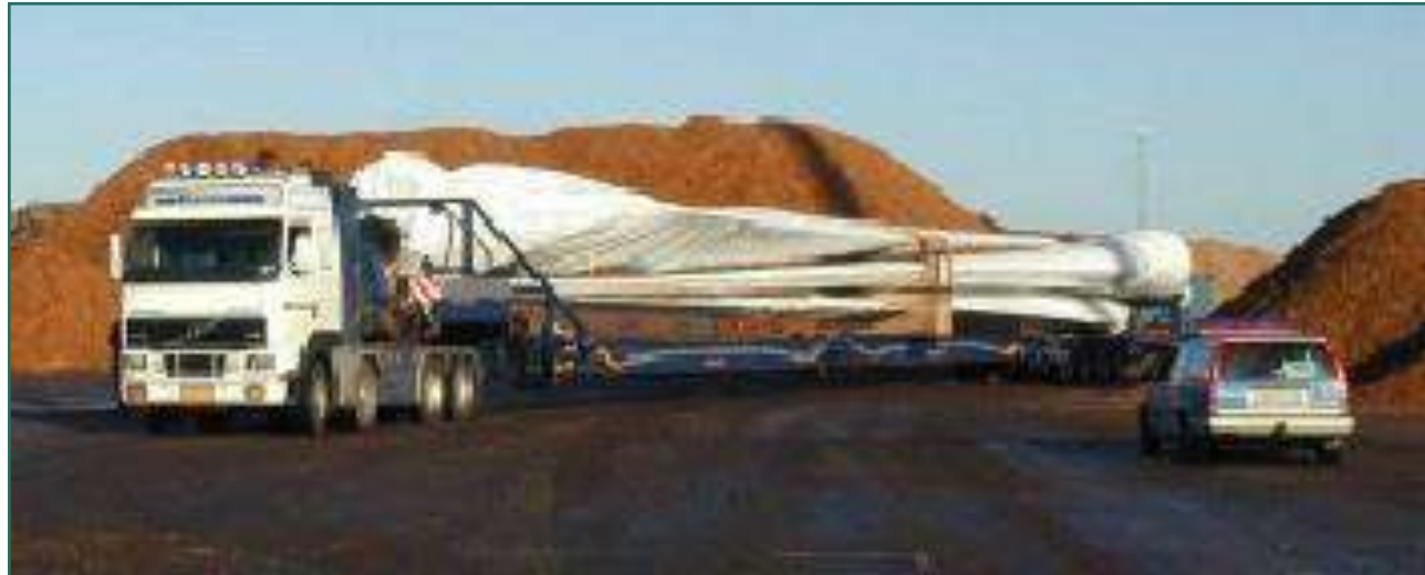
Figure 49 : Transport sur remorque des pales
